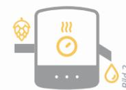
In die Würzpfanne wird **der Hopfen** hinzugegeben und für ca. eine Stunde **eingekocht**. Anschließend werden noch verbliebene Trübstoffe aus der Lösung entfernt. Danach wird die Würze heruntergekühlt und **die Hefe** wird hinzugegeben.
