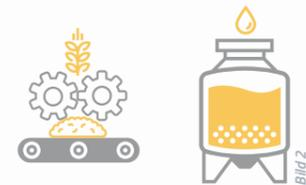
Das **Malz** (veredelte Braugerste bzw. -weizen) wird **gemahlen** und anschließend im Maischebottich mit **Wasser** vermischt. Die Maische wird auf verschiedene Temperaturen **erhitzt**, sodass wasserunlösliche Stärke in **Malzzucker** umgewandelt wird. Die für den Brauprozess wichtigen Stoffe des Malzes gehen in dieser Phase in den Sud über.
